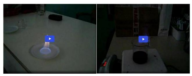
Nel vino c'è alcool, come i bambini già sanno. Se riscaldo il vino, l'alcool "vola" fuori e posso bruciarlo evidenziandone la presenza. Con la piastra riscaldante, un becher pyrex riempito a metà di vino, procediamo. L'alcool del vino brucia (due filmati)
